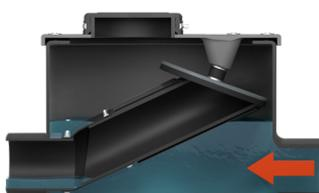
Wenn ein Rückstau auftritt, wird das Schwimmerrohr über dem Wasserstand gehalten. Der Rückstau wird somit daran gehindert, in Richtung des Hauses zu fließen.
