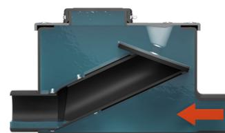
Der Wasserstand ist gestiegen und die Kammer ist vollständig gefüllt. Das Rohrende wird gegen die Dichtungsscheibe gedrückt. Das Schwimmerrohr kehrt in seine ursprüngliche Position zurück, wenn der Wasserstand in der Kammer sinkt.
