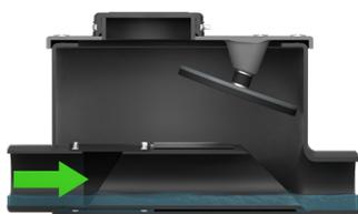
Der WaBack in Normalposition. Er funktioniert wie eine gewöhnliche Inspektionskammer. Das Abwasser fließt frei und ohne Einschränkungen durch das Ventil.
